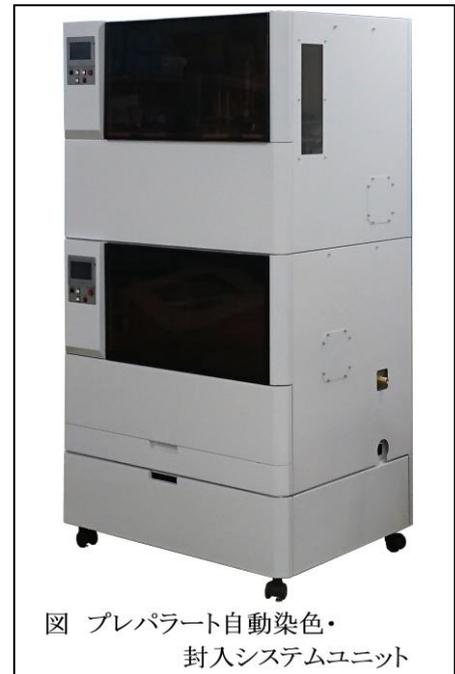
図 プレパレート自動染色・封入システムユニット
