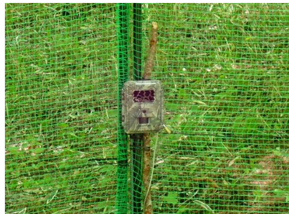
タイムラプスカメラ設置状況
