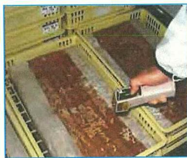
照射温度計による計測
