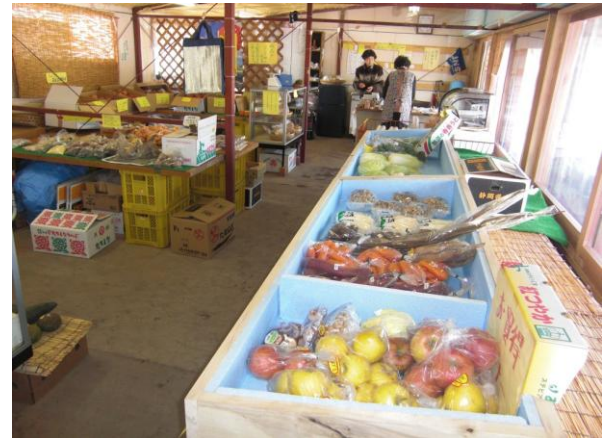
店内風景、陳列ケースは夜間の凍結対策としてケースを作り、木枠内に断熱材を張り合わせました。
